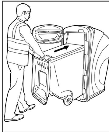
3. Empuje el cubo dentro del contenedor de modo que las ruedas se ubiquen en la posición adecuada en la base.
